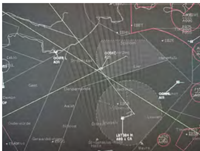
Positiebepaling via Direction Finder of m.a.w. aan de hand van triangulatie.
